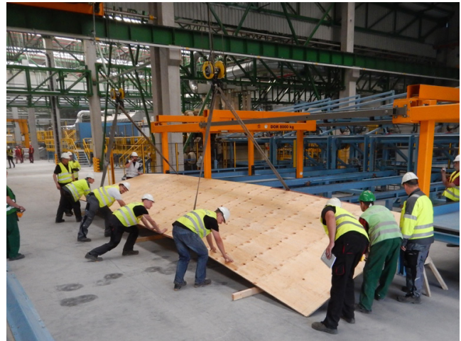
Heinäkuussa 2015 puristettiin Steicon Czarna Wodan tehtaalla ensimmäinen LVL-aihiö, jossa on seitsemän viilukerrostä ja se on 21 mm paksu, 2,5 metriä leveä ja 11 metriä pitkä.
