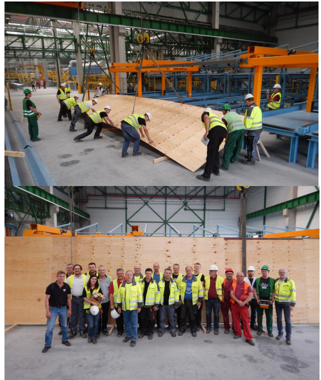
Heinäkuun puolivälissä puristettiin Steico Spolkan Czarna Wodan tehtaalla Puolas- sa ensimmäinen LVL-aiho, jossa on seitsemän viilukerrosta ja se on 21 mm paksu, 2,5 metriä leveä ja 11 metriä pitkä. Raute sai tilauksen viilupalkin (LVL, Laminated Veneer Lumber) valmistamiseen tarvittavista koneista ja laitteista Czarna Wodaan kesäkuussa 2014.
